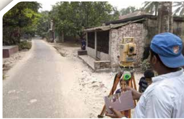
৩. Total Station মেশিনের মাধ্যমে বাড়ির স্থানাঙ্ক নির্ধারণ
